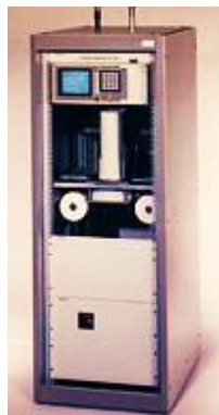
Obr. 4.4. Monitor aerosólov. Vzduch sa presáva cez filtračnú pásku, kde sú aerosóly zachytené. Na detekciu alfa a beta žiarenia sa používa kremikový detektor typu PIPS alebo scintilačný detektor ZnS+plastik.
