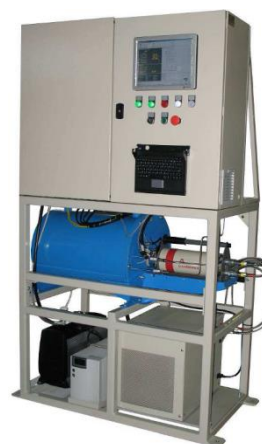
Obr. 4.4. Monitor aerosólov. Vzduch sa presáva cez filtračnú pásku, kde sú aerosóly zachytené. Na detekciu alfa a beta žiarenia sa používa kremikový detektor typu PIPS alebo scintilačný detektor ZnS+plastik.
