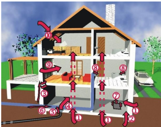
Obr. 1.12. Zdroje radónu v objektoch pozemných stavieb.
